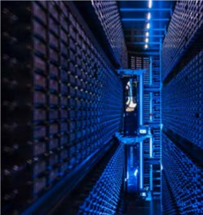
Bibliothèque de stockage à bandes magnétiques du CC-IN2P3. © Cyril FRÉSILLON / CC IN2P3 / CNRS Images
